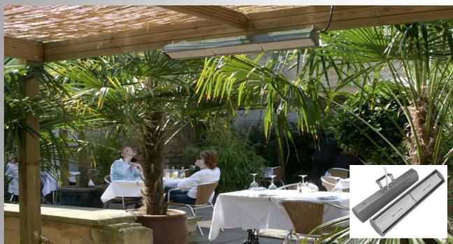
Le modèle Advantage IR 3 se compose de 3 éléments en céramique à fortes émissions, montés dans une unité réfléchissante directionnelle. Il est conçu pour chauffer doucement les personnes dans un espace intérieur par l'infrarouge. La chaleur infrarouge est émise depuis la surface chaude des éléments céramiques et réchauffe les personnes directement sans chauffer l'air entre les deux.
